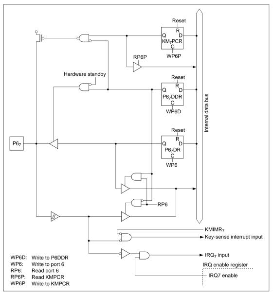
Figure C.6 (d) Port 6 Block Diagram (Pin P67)
