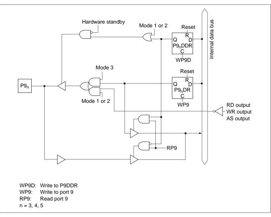
Figure C.9 (d) Port 9 Block Diagram (Pins P9<sub>3</sub>, P9<sub>4</sub>, P9<sub>5</sub>)
