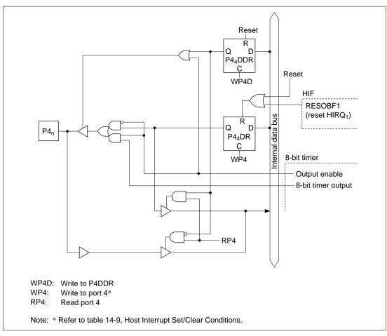
Figure C.4 (d) Port 4 Block Diagram (Pin P4<sub>4</sub>)
